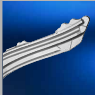
Landeklappenträger 2.450 mm x 630 mm x 160 mm 371 kg
