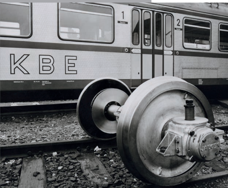
Aluminium-Stahl-Radsatz der Köln-Bonner Eisenbahn
