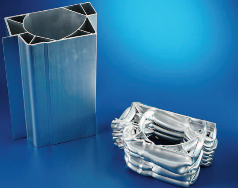
Abb. 3: Schwellerprofil für das AUDI TT Cabrio vor und nach Crashverformung Fig. 3: Door sill profile for the AUDI TT convertible, before and after crash deformation
